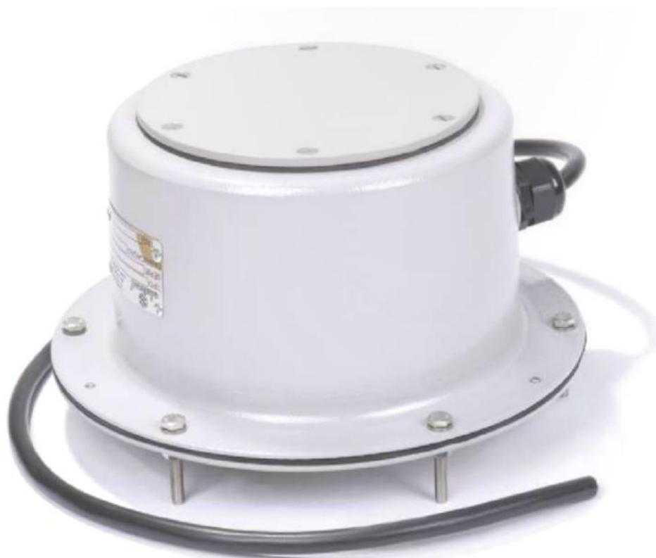
Chave de nível do tipo “diafragma” ou “membrana”, para uso em ambiente interno ou externo, com elevado grau de proteção, construída com materiais resistentes as intempéries e a ambientes agressivos, o que a torna uma chave ideal para uso em minerações e siderurgias. Indicada para monitorar o nível de “chute” de transportadores de correia e silos de materiais sólidos a granel em geral.
