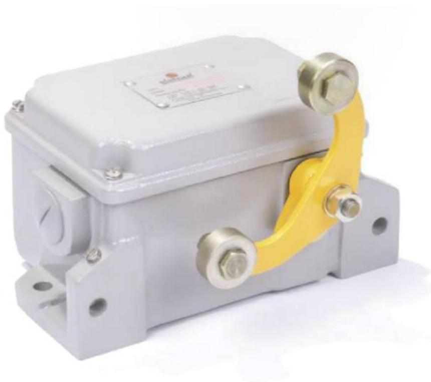
Chave fim de curso com alavanca de acionamento do tipo "Lira" com roldanas de acionamento em uma direção sem retorno automático, contatos de ação instantânea, produzida especialmente para uso nas mais severas condições de trabalho, quando se necessita de um alto grau de proteção do invólucro e baixa manutenção.
