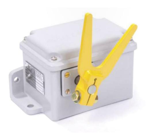
Chave fim de curso com alavanca em "V" ou "Lira com roldanas", com acionamento em uma direção sem retorno automático, com contatos de ação instantânea, produzida especialmente para uso nas mais severas condições de trabalho, quando se necessita de uma chave com alto grau de proteção do invólucro e baixa manutenção.
