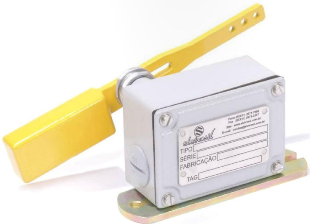
Chave fim de curso de acionamento por contrapeso, com 01 contato de ação instantânea utilizada como “limite de emergência”, com atuação em circuitos de comando em corrente alternada.
