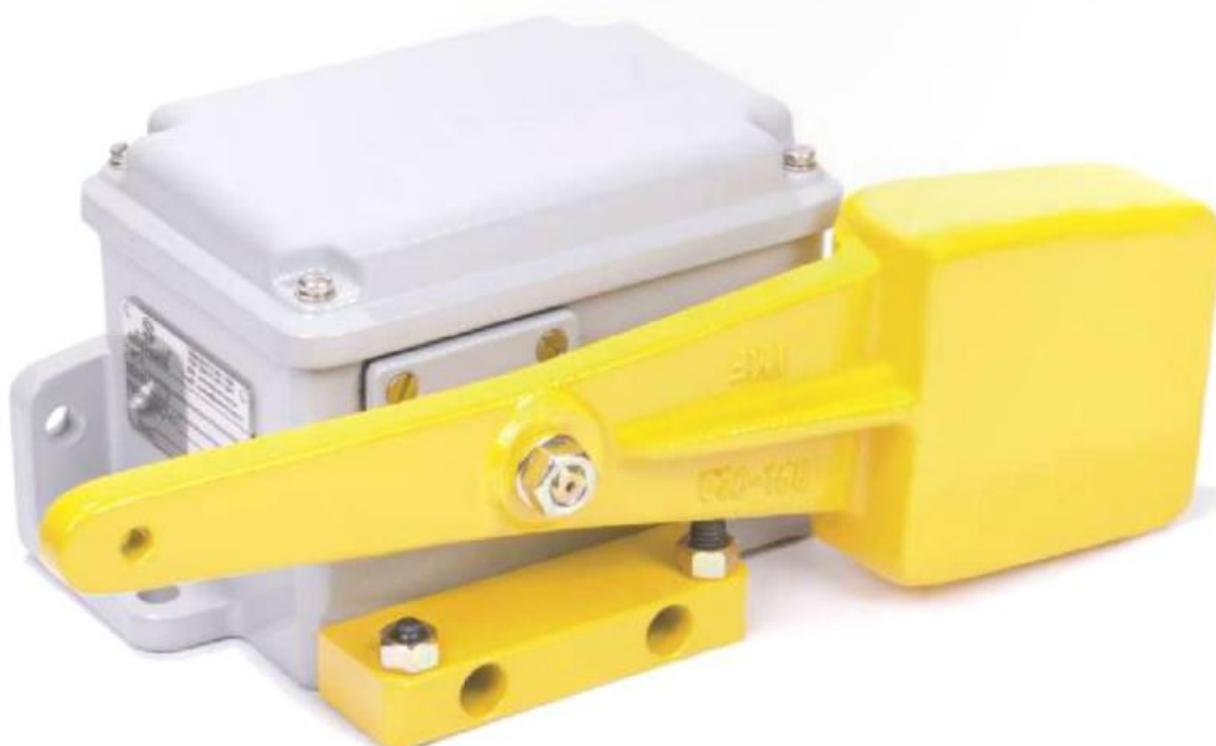
Chave fim de curso de acionamento por contrapeso, com 02 contatos de ação instantânea utilizada como “limite de emergência”, com atuação em circuitos de comando em corrente contínua ou alternada, principalmente em acionamentos com inversores de frequência.
