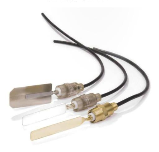
As "chaves de fluxo" ou "fluxostatos" do tipo pá, fabricadas pela Eletrosil, foram desenvolvidas para funcionar como indicadores de fluxo em tubulações hidráulicas para monitoramento e automação de sistemas, sendo utilizadas também para indicação de fluxo de ar e gases em tubulações de ventilação ou exaustão.
