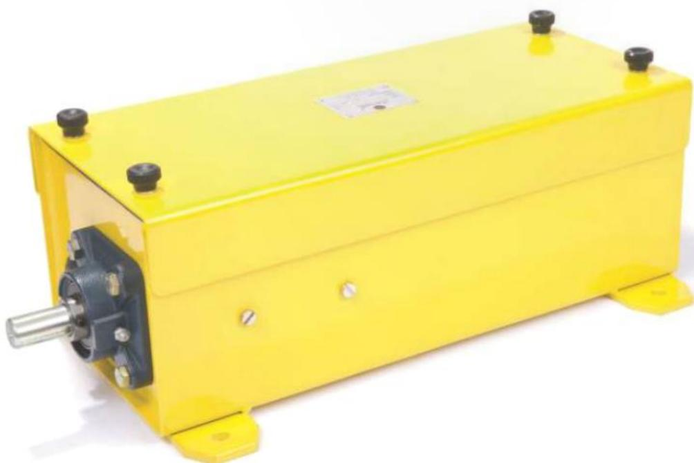
Chave rotativa programável também conhecida como "chave copiadora", com dois estágios de contatos elétricos, dotada de embreagem e freio eletromagnético, que permite a alteração do ponto inicial de atuação da chave sem a necessidade de alterar a programação ou desconectar mecanicamente a chave, com contatos elétricos de regulagens individuais, programáveis e repetidas a cada 360° de giro no eixo (à cada rotação).
