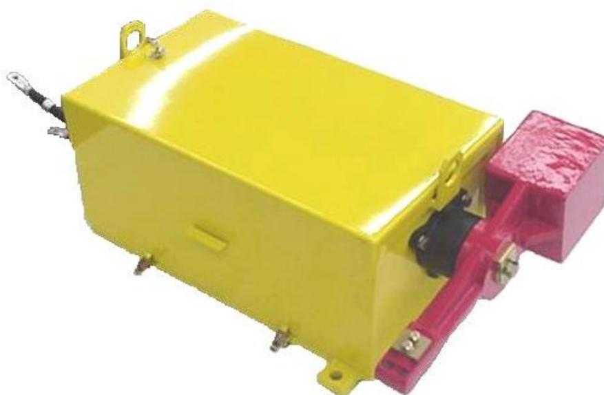
Chaves fim de curso de acionamento por contrapeso, conhecidas também como “Limites de Potência”, para um ou dois motores simultaneamente, com contatos de ação instantânea e rearme automático podendo ser reversíveis para frenagem dinâmica, utilizadas em corrente contínua ou alternada atuando diretamente no circuito de força interrompendo o(s) motor(es) em qualquer regime de trabalho.
