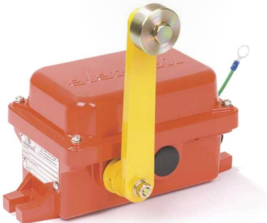
Chave fim de curso para serviço pesado do tipo “alavanca com roldana”, com acionamento em uma direção e dois sentidos, com retorno automático, e até 3 estágios de atuação dos contatos, especialmente projetada para operar em ambientes agressivos.
