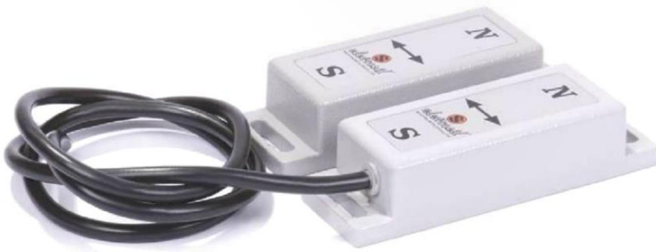
Chaves fim de curso com acionamento magnético, sem peças móveis ou contato mecânico possuem alto grau de proteção (IP-67), indicadas para uso em ambientes extremamente agressivos ou com grandes dificuldades para manutenção, pois não possuem itens que necessitem de manutenção preventiva.
