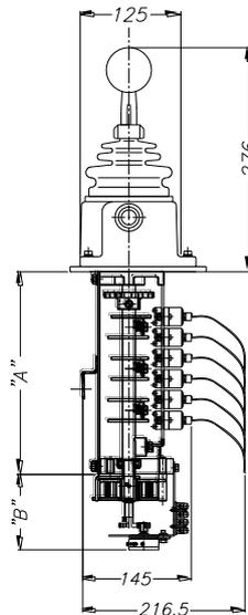
CHAVE SEM CAIXA PARA MONTAGEM EM CONSOLE COM SENSOR E TRANSFORMADOR VARIÁVEL
