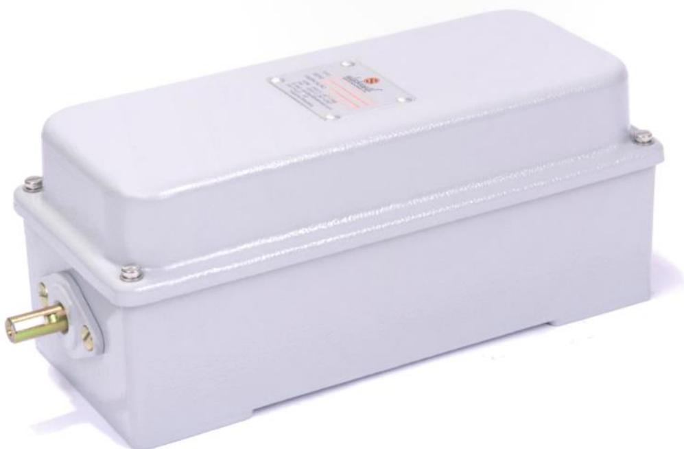
Chave fim de curso rotativa do tipo “contadora de voltas”, com acionamento através de rosca sem fim, e contatos com regulagem deslizante sem cames, recomendada para uso em ambientes agressivos, onde se necessite de uma regulagem extremamente simples mas com grande confiabilidade eletromecânica e baixa manutenção.
