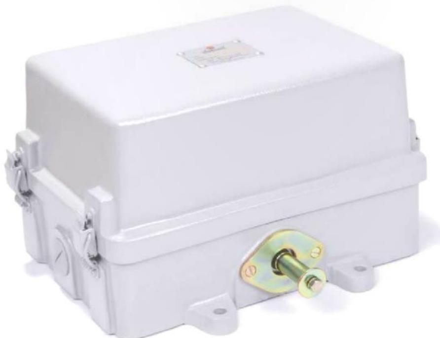
Chave fim de curso rotativa do tipo "contadora de voltas/ programável" também conhecida como "seletora", "copiadora" ou de "chave de cames", destinada a operar em qualquer tipo de máquina ou equipamento que necessite de uma monitoração/ automação para posicionamento ou limitação do número de voltas no eixo.
