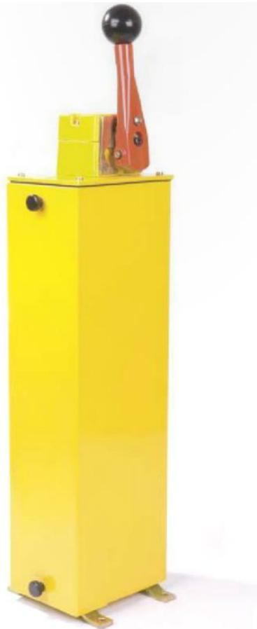
Chave combinadora para movimento simples (uma direção e dois sentidos), também conhecida como “chave mestra”, “chave controladora” ou “manete”, desenvolvida especialmente para uso siderúrgico, em corrente contínua (250Vcc) ou alternada, com elevada frequência de operações e uso ininterrupto, comandando diretamente os contatores de força, sem o auxílio de reles, ou para acionar inversores de frequência ou CLP’s através de saídas analógicas.
