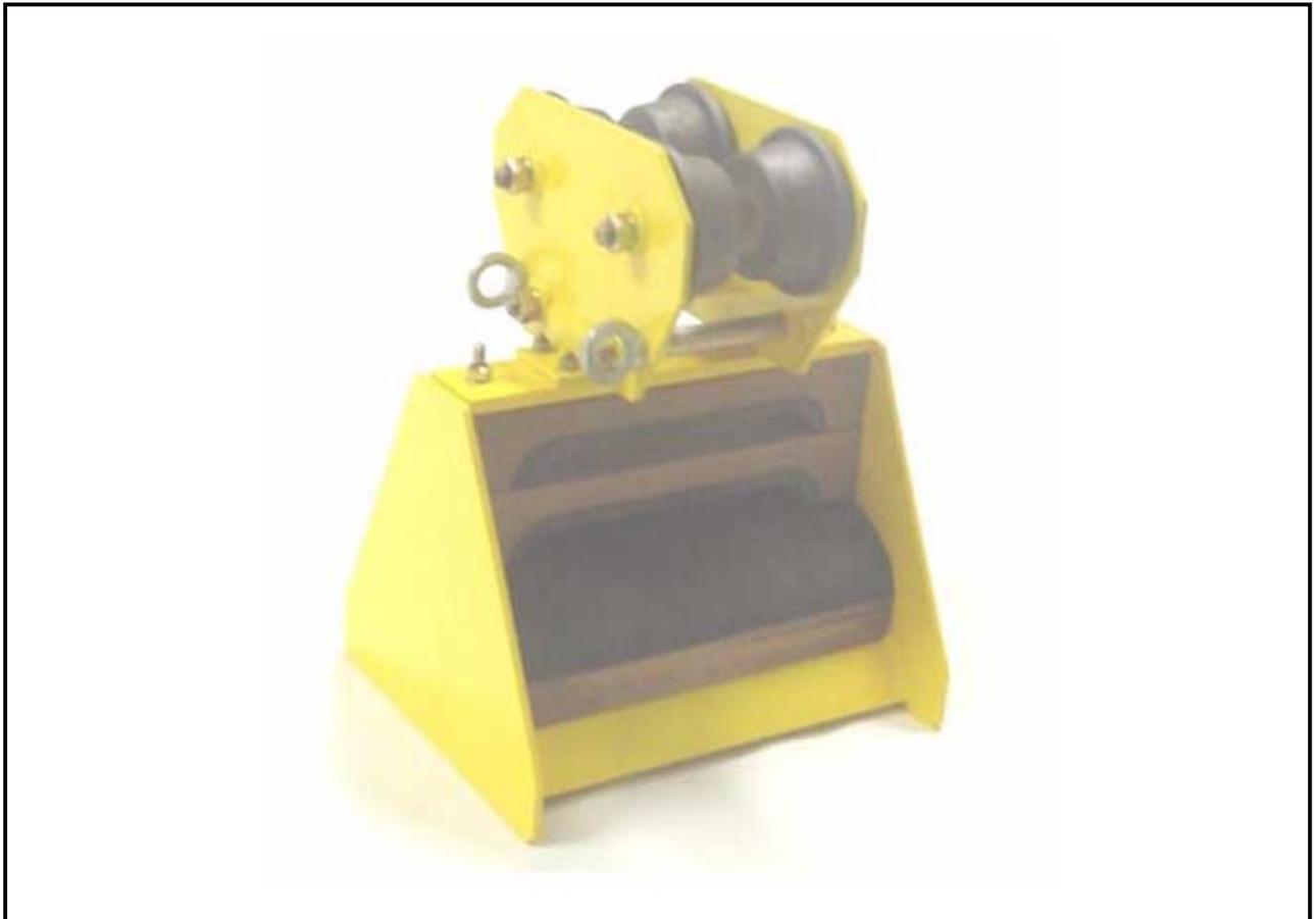
Carros porta cabos para serviços pesados, com até três níveis, adequados para uso de cabos redondos ou chatos, são fabricados em aço carbono (inox sob encomenda); rodízios em aço temperado com rolamentos blindados de esferas, construídos especialmente para uso nas mais severas condições de trabalho, em qualquer tipo de ambiente, com um alto grau de confiabilidade e grande resistência mecânica.
