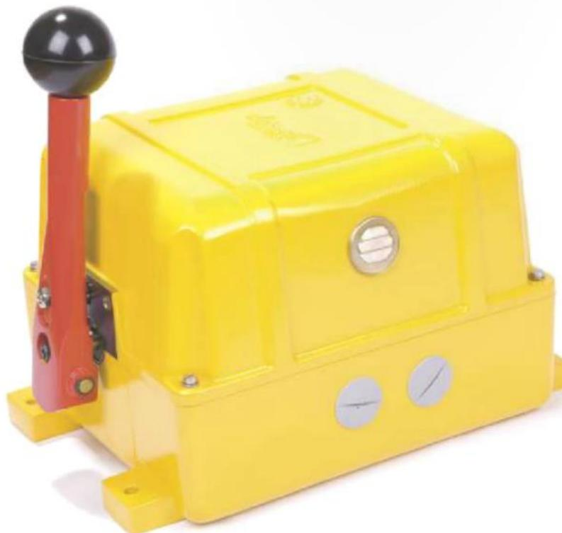
Chave combinadora, “manete” ou “controladora”, de movimento simples (uma direção), para montagem sobre mesa, construída em alumínio fundido (IP-55), desenvolvida especialmente para uso siderúrgico, em corrente contínua ou alternada, comandando diretamente os contatores de força, sem o auxílio de reles, com elevada frequência de operação e uso ininterrupto.
